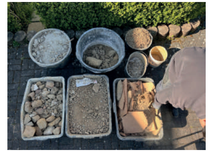
Abb. 1.: Ausgangsmaterial – Lehmdämmplatten, die aufbereitet werden müssen, damit sie im weiteren Verlauf wiederverwendet werden kann.
