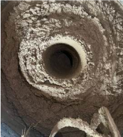
Abb. 16: Konsistenztest: Lehmputz sollte im Inneren zerfließen
