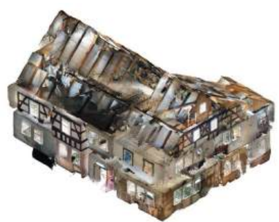
Abb. 28: Bestandsaufnahme des Hauses Döschnitz: Innenwände
