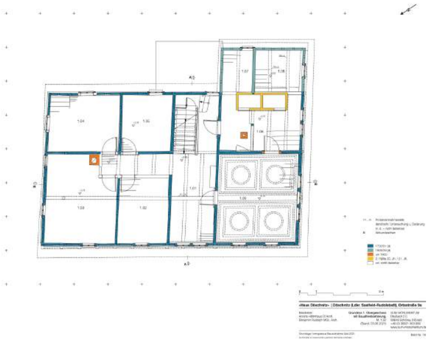
Abb. 2: Baualterskartierung; das Bürgermeisterzimmer, Raum 1.03 soll zur bauzeitlichen Schicht ~um 1700, gehören
